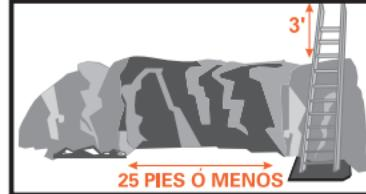
Una persona competente debe inspeccionar las zanjas a diario y cuando las condiciones cambien. Una zanja sin protección es una tumba. No entre a una zanja que no está protegida.
